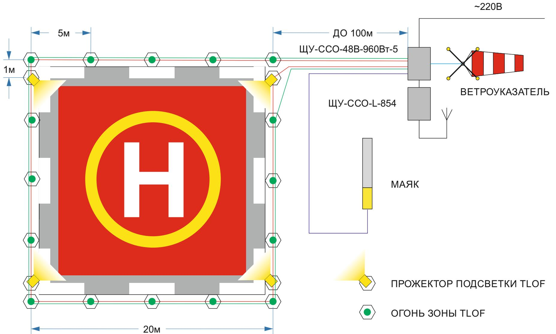
ЦЕПИ - ПРОЖЕКТОР ПОДСВЕТКИ TLOF, ОГОНЬ ЗОНЫ TLOF, МАЯК, ВЕТРОУКАЗАТЕЛЬ, ПОДКЛЮЧАЮТСЯ КАЖДАЯ, К СВОЕМУ ВЫХОДУ КОНТРОЛЛЕРА ДЛЯ ОБЕСПЕЧЕНИЯ РАЗНЫХ РЕЖИМОВ РАБОТЫ. ДЛЯ БОЛЕЕ ПОДРОБНОГО ОПИСАНИЯ СМОТРИ ПАСПОРТ НА КОНТРОЛЛЕРА И СООТВЕТСТВУЮЩИЙ ЩИТ УПРАВЛЕНИЯ.
